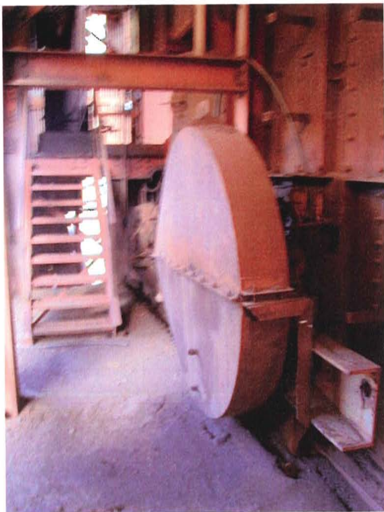
Couvert d'engrenage plein d'huile retrouvé à l'intérieur du concasseur.
