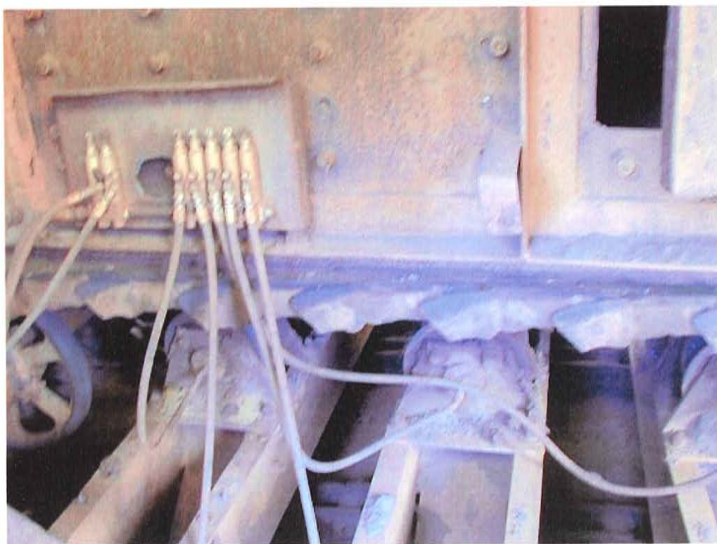
Série de roulements du convoyeur à la base du concasseur, démontrant de la graisse.
