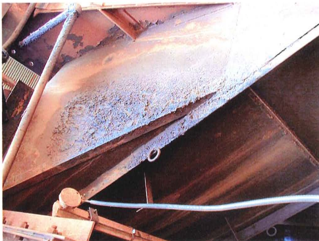
Trace de contamination sur les parois intérieures du concasseur.
