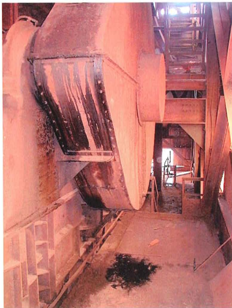
Base du concasseur démontrant un suintement d'huile.
