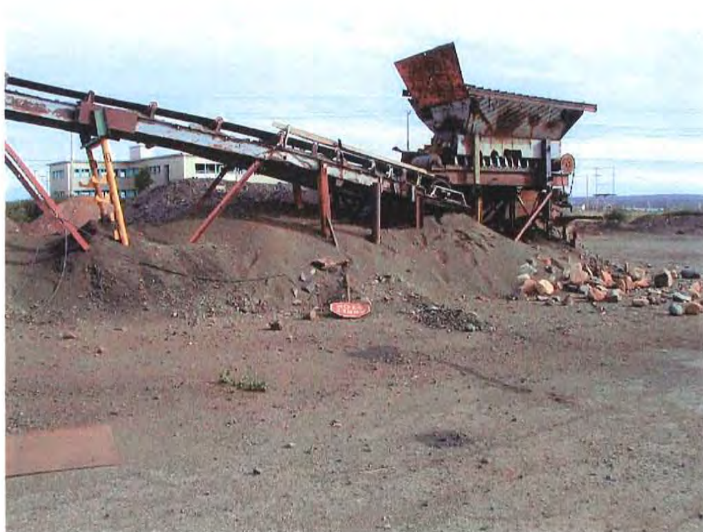
Tamiseur situé au nord du garage encore en état de fonctionner.
