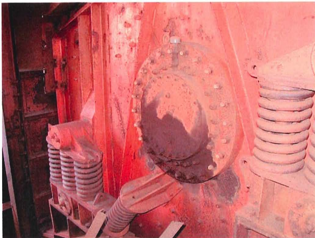
Base du concasseur démontrant un suintement d'huile.
