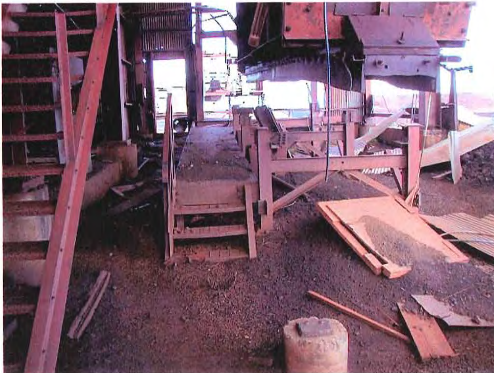
Sol souillé par les hydrocarbures à la base du concasseur, \pm 450 \text{ m}^3 .
